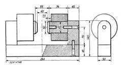
Fig. 3. Magnet für die Magnetronröhre.
