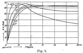
Verlustwinkel von Eis in Abhängigkeit von der Frequenz (nach Smyth und Hitchcock).
