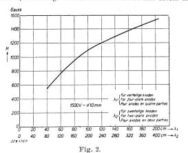
Für das Magnetron erforderliche Feldstärke in Funktion der zu erzeugenden Wellenlänge.
