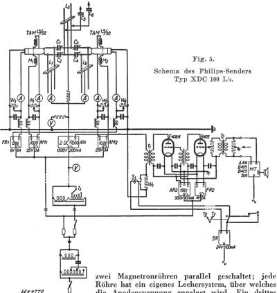
Röhre hat ein eigenes Lechersystem, über welches die Anodenspannung angelegt wird. Ein drittes gemeinschaftliches Lechersystem dient für die Abstimmung. Die Modulation erfolgt über den Transformator
