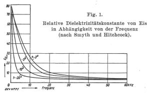
tischen Wert 80 aus mit wachsender Frequenz ab und nähert sich dem Quadrat des optischen Brechungsindex, wie das Fig. 1 zeigt.
