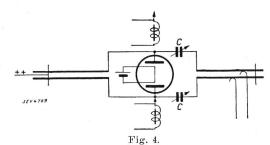
Prinzipschaltung eines Magnetron-Oszillators.
