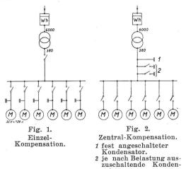
Motor zusammengeschalteten, für mittlere Belastungen bemessenen Kondensator wird nun bei leerlaufendem Motor kapazitive Blindleistung ins Netz geliefert, während bei Volllast die induktive Blindleistung nicht ganz beseitigt werden kann. Eine restlose Beseitigung der Blindleistung ist demnach nicht möglich und es entstehen ganz allgemein folgende Nachteile:
