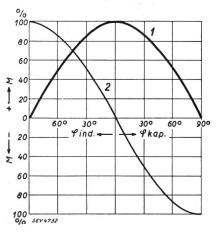
Fig. 6. Drehmoment des Wirkverbrauch-(1) und Blindverbrauch- (2) Zählersystems.
