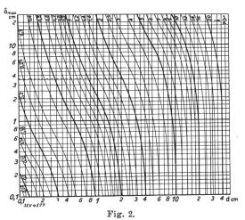
Isolationsauftrag  $\delta_{max}$ , bei welchem der thermische Widerstand gleich demjenigen des blanken Leiters ist.
