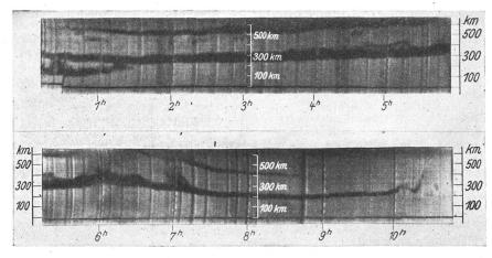
Fig. 2. Echoaufzeichnung vom 12. Februar 1933 bei 150 m Wellenlänge (2 M Hz).
