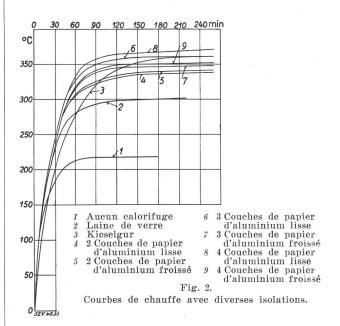
C'est particulièrement dans le cas d'appareils qui doivent être chauffés chaque jour à nouveau que la faible capacité thermique de l'Alfol joue un rôle particulièrement important; c'est pourquoi le calorifuge Alfol est appliqué de plus en plus dans le domaine du chauffage et de la réfrigération électrique.
