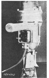
Fig. 10. Perceuse électrique munie d'un condensateur antiperturbateur.
