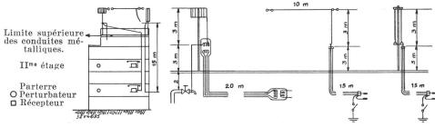
Fig. 3a. Disposition des antennes B sur maison en briques et ciment armé.
