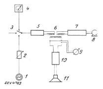
Fig. 4. Dispositif de mesure ayant servi à la détermination de la perturbation intolérable.
