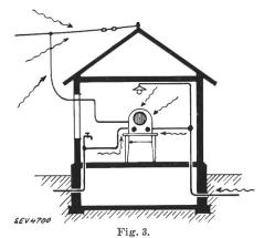
Mode d'action des perturbations radioélectriques sur un appareil radiorécepteur.
