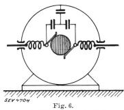
Schéma de principe de filtre antiperturbateur appliqué à un moteur électrique à collecteur.
