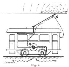
Tensions perturbatrices produites par le moteur et le trolley d'un tramway électrique.
