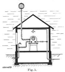
Installation radioréceptrice complètement protégée contre les PR transmises par les canalisations. L'antenne blindée s'élève au-dessus de la «zone locale» de PR figurée par les traits horizontaux.
