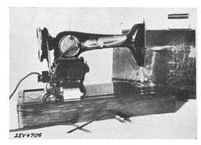
Fig. 8. Moteur de machine à coudre muni d'un condensateur antiperturbateur (fixé en dessous du moteur).
