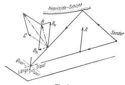
Fig. 1. Empfang der Komponenten A, B, C durch Längs-, Hoch- und Querdipole.
