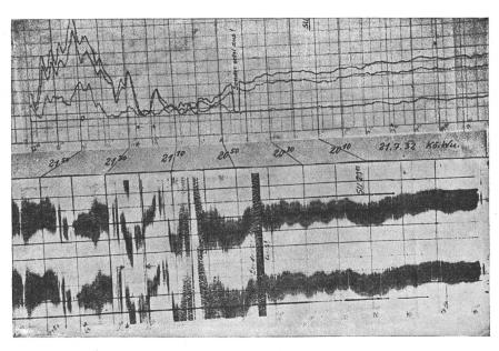
Fig. 5. Energie- und Peilregistrierstreifen zeigen den Uebergang vom Tag zur Nacht. Mit dem Absinken der Energie in den 3 Dipolen nach 20<sup>50</sup> treten grosse Peilfehler auf. Schwenkbereich des Rahmens 350°.
