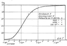
Fig. 3. Die Abhängigkeit der Schirmwirkung  $S_{eff}$  vom Produkt  $\left\{ \text{Blechstärke (mm)} \times \text{Leitwert } \begin{pmatrix} \sigma_{\text{Cu}} = 55.5 \\ \sigma_{\text{Zn}} = 16.6 \end{pmatrix} \times \text{Frequenz (s-1)} \right\}$
