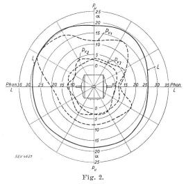
Polarer, ebener Verlauf der Lautstärke L (Phon) und des Schalldruckes der stark störenden Teiltöne des Luftschallspektrums  $P_{\mathcal{V}}$  (Skalenteile  $\alpha$ ) des Analysatorinstrumentes eines leerlaufenden 3-PS-Drehstromasynchronmotors im stark gedämpften Raum.
