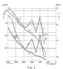
Trennung des mechanisch und des magnetisch erzeugten Schalles.
