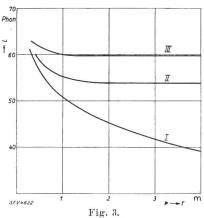
Lautstärke L eines Motors in Phon bei verschiedenen Entfernungen r, in Metern,
