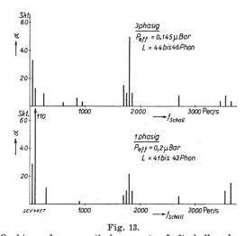
Spektrum des magnetisch erzeugten Luftschalles eines leerlaufenden Drehstrom-Käfiganker-Asynchronmotors (5 PS, 6 Pole, 50 Per./s, 54/102 Nuten) bei dreiphasigem- und einphasigem Betrieb (ohne Hilfsphase und bei gleicher Luftspaltsättigung)
