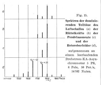
Luftschalles überhaupt — von den radialen Vibrationen der Frequenz 1800 (Fig. 15b) oder von den tangentialen Vibrationen der Frequenz 1800 (Fig. 15c) herrührt.
