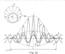
Entstehung einer einseitigen, radialen Zugkraft durch 2 Oberfelder der Polpaardifferenz 1 (schematisch).
