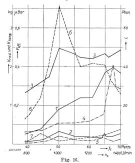
Verlauf des Schalldruckes, der Lautstärke, der radialen und tangentialen Parasitärkräfte in Funktion der Netzfrequenz f<sub>1</sub>. Anfnahme der radialen und tangentialen Kräfte mit Piezoquarzen und mit dem Analysator. Leerlaufender DrehstromKäfiganker-Asynchronmotor: 5 PS, 6 Pole, 54/102 Nuten.
