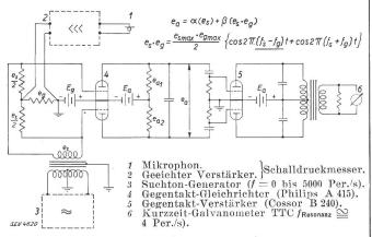
Fig. 1. Prinzipschaltung der Analysatoranlage.
