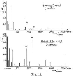
Analyse des Spektrums des magnetisch erzeugten Luftschalles eines Drehstrom-Käfiganker-Asynchronmotors
