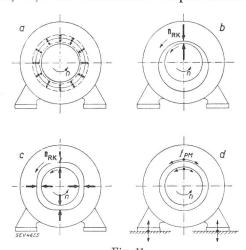
Fig. 11. Schwingungsformen des Motors durch die Wirkung der Luftspaltkräfte.
