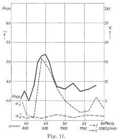
Wirkung mechanischer Resonanzen auf den Verlauf der Lautstärke L (Phon) und des Schalldruckes einzelner, stark störender Teiltöne des Spektrums.
