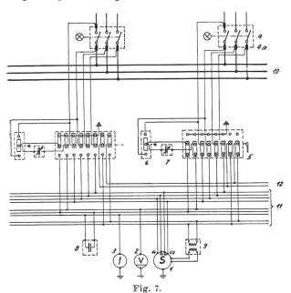
Anschluss von elektrostatischen Instrumenten an die Mess-beläge von Oelschalterklemmen.
