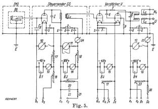
Schaltbild von Steuerquarz, Steuersender, Verstärker.
