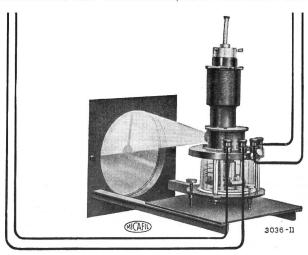
Fig. 5. Elektrostatisches Synchronoskop mit den vier Anschlussleitungen (a in Fig. 4).
