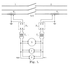
Synchronisiereinrichtung mit Röhrenverstärker zum Anschluss an Kondensatorklemmen.
