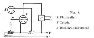
ten werden. Eine einfache Schaltung für solche Zwecke, die allerdings eine wesentlich grössere Toleranz aufweist, zeigt Fig. 4. Je mehr die Zelle Zbelichtet wird, um so positiver wird das Potential des Punktes P und um so stärker der Anodenstrom der Röhre. Der Schwellwert hängt wesentlich vom Betätigungsglied B ab; er lässt sich zudem in weiten Grenzen durch Verschieben der Abgriffe am Spannungsteiler verändern.
