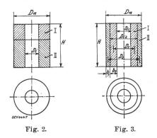
Bei der Spulenanordnung Fig. 3, die für die Ausführung bequemer ist, wird  $l_2 \geq l_1$ .
