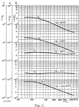
Abhängigkeit der Hochfrequenzgrössen von der Messfrequenz.
