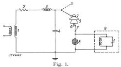
Schaltung zur Untersuchung der Hochspannungsisolatoren.
