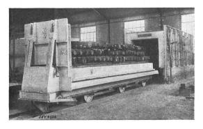
Fig. 11. Glühofen für Eisenknüppel, 350 kW.
