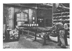
Fig. 6. Emaillierofen mit Schnelladevorrichtung, 110 kW.
