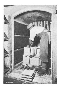
Fig. 8. Chromnickel-Muffelofen zum Brennen von Keramik, 80 kW.
