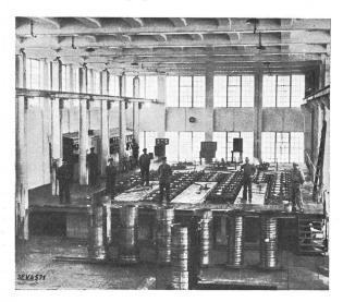
Fig. 1. Blankglühofenanlage, System Brown Boveri-Grünewald bei Sandvikens Jernverks A/B Sandviken (Schweden).
