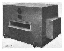
Fig. 5. Schmiedeofen mit Silitbeheizung, 12 kW.
