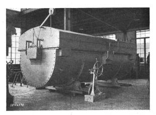
Fig. 3. Widerstandsschmelzofen für Aluminium, 200 kW.
