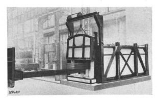
Fig. 4. Glühofen für Kupfer, Messing, Neusilber usw. Einsatz bis zu 8 t, 270 kW.
