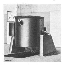
Fig. 2. Niederfrequenz-Induktionsofen für 600 kg Einsatz.
