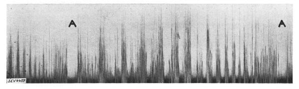
Störungsdiagramm einer Strassenbahn mit zweidrähtiger Fahrleitung. Abstand der Aufhängepunkte «A»: ca. 30 m; Oszillogramm beginnt links; Aufnahmedauer ca. 9 s.
