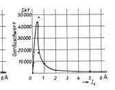
Fig. 5. Störkennlinie eines einfachen Beidrahtes von 30 m Länge.
