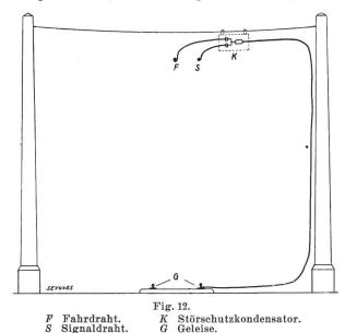
Bereits die Anwendung des Kondensators C1 bringt eine wesentliche Reduktion der Geräuschwerte, wie aus folgender Messtabelle für einen Signaldraht von 30 m Länge und  $I_s$ = 0.5 A hervorgeht:
