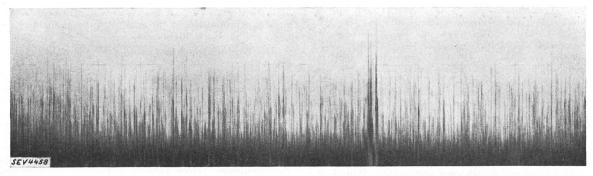
Fig. 3. Gleichmässig kratzendes Störgeräusch einer Strassenbahn mit eindrähtiger Fahrleitung. Aufnahmedauer 9 s.
