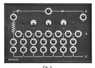
Ansicht des Modells zur Bestimmung der Fehlerströme und Berührungsspannungen in offenen Normalspannungsnetzen.
