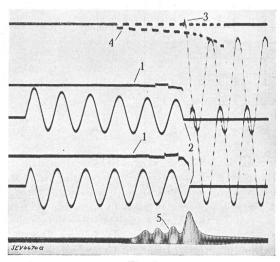
Oszillogramm einer dreiphasigen Abschaltung im 87-kV-Oelschalter mit Konvektoren.
