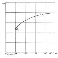
Fig. 3. Abhängigkeit der maximal auftretenden Lichtbogenlänge von der Betriebsspannung.
