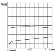
Fig. 2. Verhalten des Konvektors bei verschiedenen Stromstärken. t Lichtbogenlänge.
