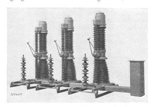
Fig. 5. Dreipolige Konvektorschaltergruppe für 150 kV. Abschaltleistung 1800 MVA. In den Stützisolatoren sind Stromwandler eingebaut.
