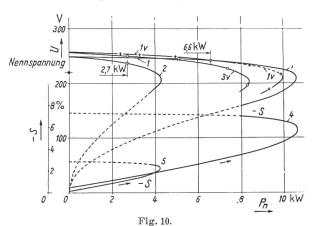
Belastung des durch Kondensatoren selbsterregten Asynchrongenerators.
