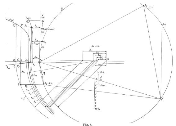
Durch Kondensatoren selbsterregter Asynchrongenerator, Betriebsdiagramm wie Fig. 7, maßstäblich richtig gezeichnet für einen für 220 V gewickelten vierpoligen 10 PS-Asynchronmotor mit Kurzschlussanker.
