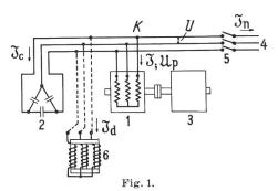
Schema des durch Kondensatoren selbsterregten Asynchrongenerators,
