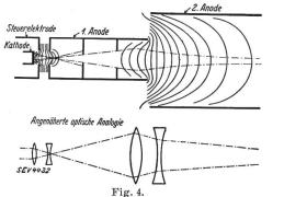
Elektrostatisches Feld des Elektrodensystems im Ikonoskop.
