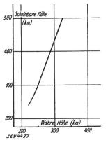
Fig. 2. Errechnetes Verhältnis der wahren zur scheinbaren Höhe für  $\lambda=70$  m. (Försterling und Lassen.)
