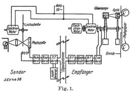
Schaltschema von Sende- und Empfangsanlage.
