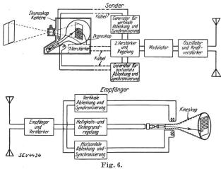
Schaltung einer vollständigen Fernseh-Sende- und Empfangsanlage.
