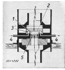
Fig. 18. Mikrophon-Eicheinrichtung. 1 Thermophonfolie. 2 Kondensator-mikrophon. 3 Druckkammer.
