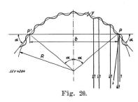
parallelem, schräg auffallendem Licht beleuchteten Platte aus. In Fig. 20 ist schematisch ein gekrümmter Rillenzug mit dem Radius R aufgezeichnet. Das von unten her einfallende parallele Licht wird je nach
