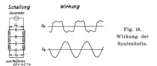
fung 1 Neper besagt demnach, dass Spannung und Strom am Eingang 2,7 mal grösser sind als Spannung bzw. Strom am Ausgang. Die Steilheit des Dämpfungsanstieges nimmt zu mit steigender Gliederzahl der Kette. Fig. 10 zeigt eine Spulenleitung. Sie lässt Frequenzen unterhalb der Grenzfrequenz, die vom Produkt von Induktivität und Kapazität eines Gliedes abhängt, passieren und glättet deshalb einen Wechselstrom mit überlagerten Oberwellen.
