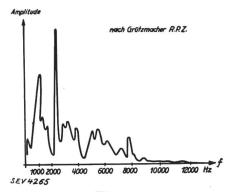
Fig. 1. Geräusch eines Staubsaugers.
