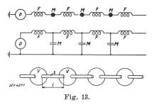
mente und die Kirchhoffschen Gesetze bestimmend sind, so kann also jedes linear ausgedehnte mechanische System mit vollkommener Analogie durch ein elektrisches Ersatzschema dargestellt werden, wobei z. B. der ideale elektrische Transformator einem mechanischen Hebel entspricht.
