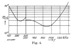
Kurve der Spiegelfrequenzempfindlichkeit.  $\frac{U_s}{U_1} = F(f); P = 50 \text{ mW}; f_m = 400 \text{ Hz}; m = 30\%.$
