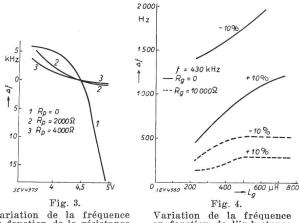
Variation de la fréquence en fonction de la résistance insérée dans le circuit de plaque et de la tension de chauffage (abcisse).
