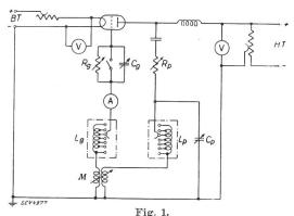
Schéma de l'oscillateur expérimental.
