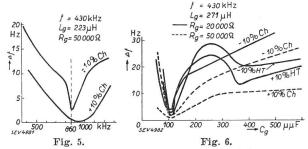
Variation de la fréquence de l'oscillateur en fonction de la fréquence propre du circuit de grille.
