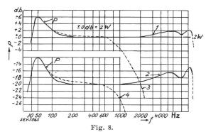
Niederfrequenzkurve. P=F (f);  $U_1=$ konst. = 0,5  $\vee$  (Kurve 1) P=F (f);  $U_1=$ konst. = 0,05  $\vee$  (Kurve 2) Kurven 3 und 4 wie Kurven 1 und 2, aber bei eingeschaltetem Klangregler.
