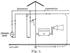
Entstehung unsymmetrischer Störströme durch Netzunsymmetrien.
