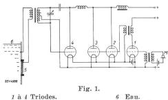
Triodes. Eau. Microphone. Condensateur au quartz.
