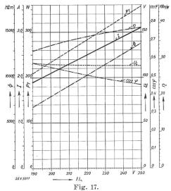
Caractéristique de service de la lampe Osram à vapeur de mercure, type Hg H 1000. Lampe Nº 5635, bobine de self ELZ Nº 18b. (Mêmes désignations que pour la figure 16.)
