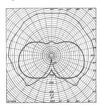
Fig. 22. Courbes des intensités lumineuses du luminaire BAG «Plaza» 7265, avec lampe à incandescence 220 V, 300 W, dépolie intérieurement.
