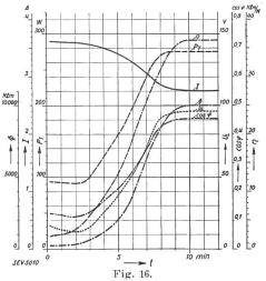
Caractéristique d'amorçage de la lampe Osram à vapeur de mercure, type Hg H 1000.
