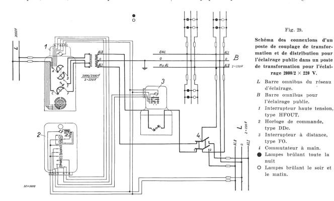
(et ainsi du transformateur) et de l'interrupteur basse tension. Ces couplages ont les effets suivants: Conducteur I: Soir, enclenché 220 V; 00.30 h., commuté 190 V; 05.00 h., commuté 220 V; matin, déclenché. Conducteur II: Soir, enclenché 220 V; 00.30 h., déclenché; 05.00 h., enclenché 220 V; ma-
