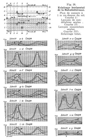
La courbe I correspond aux lampes des candélabres, la courbe II aux lampes suspendues et la courbe III à l'éclairage résultant. Le calcul s'est fait selon le même procédé que pour l'éclairage horizontal. Le plan de situation indique les points de mesure et ceux où l'intensité d'éclairement est maximum ou minimum.
