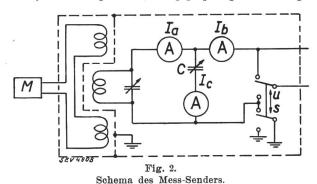
takt), wenn an gegenüberliegenden Stellen der beiden Leiter entgegengesetzte, aber gleichgrosse Ströme fliessen, und unsymmetrisch (auch gleichphasig oder im Gleichtakt), falls der Strom in beiden Drähten in gleicher Richtung fliesst und beispielsweise die Erde den Stromkreis ergänzt. Meist werden beide Komponenten überlagert vorhanden sein, und man kann umgekehrt die Gesamtleistung bestimmen durch separate Messung der Einzelkomponenten.
