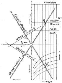
Fig. 2. Nomogramm für die Formel von Colard.  $T_{n} = T \left[ 1 - \left( 1 + \frac{\varepsilon a}{2 n \times} - \sqrt{\frac{\varepsilon a}{n \times} + \left( \frac{\varepsilon a}{2 n \times} \right)^{2}} \right)^{n} \right]$
