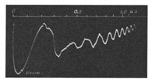
Fig. 10. Verlauf einer Spannungswelle für biologische Versuche.
