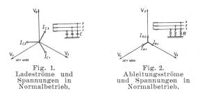
bilden auch die Ableitungsströme ein symmetrisches System. Sie sind mit den Spannungen  $V_1$ ,  $V_2$  und  $V_3$  in Phase und deshalb als reine Wirkströme aufzufassen (Fig. 2).
