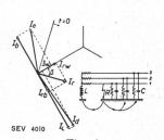
Blind- und Wirkkomponente Reststromes in einem kompensierten Netz.
