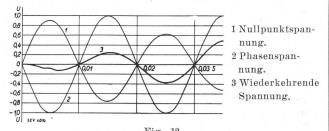
Verlauf der an der Erdschlußstelle wiederkehrenden Spannung in einem kompensierten Netz. Resonanzabstimmung.
