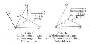
nenten, den Ladestrom und den Ableitungsstrom der beiden gesunden Phasen. Der Ladestrom eilt der Phasenspannung der kranken Phase um 90° vor, der Ableitungsstrom ist mit der genannten Spannung in Phase (Fig. 4).
