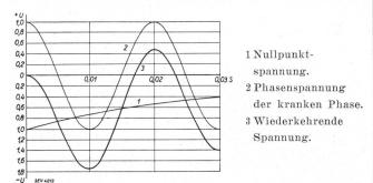
Fig. 11. Verlauf der an der Erdschlußstelle wiederkehrenden Spannung in einem isolierten Netz.
