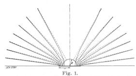
Stromverlauf in einem Metallstück bei Eintritt des Stromes durch eine ebene, kreisrunde Fläche (ausgezogene Linien) und bei Eintritt durch eine Halbkugelfläche (gestrichelte Linien).
