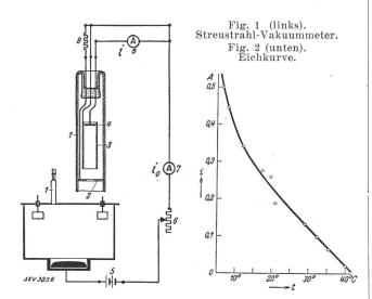
den grossen Widerstand 9 mit der Batterie 5 verbunden, was das Zünden der Entladung erleichterte. Die Blendenöffnung wirkte als Striktionskathode, wodurch der Innenraum der Hilfsanode 3 ionisiert wurde.
