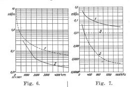
1 Kurve der reziproken Distanz. 2 Verlauf der Feldstärke bei Nacht. Ausgestrahlte Leistung 1 kW.
