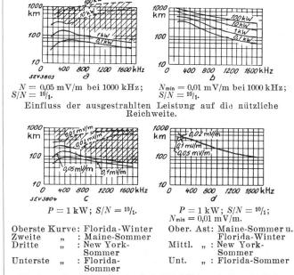
Einfluss des Störspiegels (bei 1000 kHz) auf die nützliche Reichweite.
