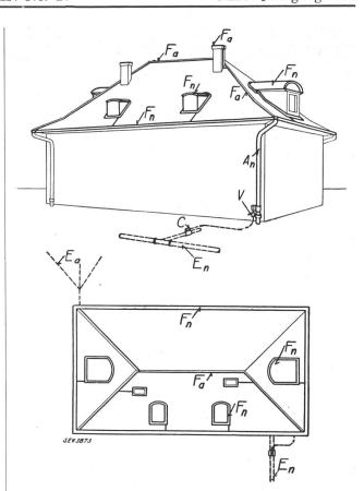
Fig. 2. Exemple d'une installation de paratonnerre.
