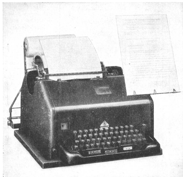
Fig. 7. Siemens-Fernschreibmaschine, Blattdrucker mit Schutzkappe.
