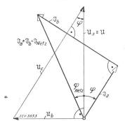
Fig. 2. Vektordiagramm eines C-Motors im «ausgeglichenen» Betriebszustand.
