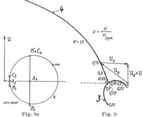
Vektordiagramm der Spannungen an der Hilfswicklung: [Ub] und am Kondensator: Ub, der beiden bereits in Fig. 7 und 8 untersuchten C-Motoren (3, 4). In Fig. 9a ist das Kreisdiagramm des zugrundegelegten Zweiphasenmotors (1) mit den die C-Motoren (3, 4) charakterisierenden Polen A, B, C (s. Gl. 13, 14).
