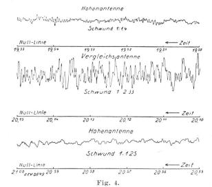
Schwundkurven der Höhen- und Vergleichsantenne bei 60 km.  $\lambda=192$  m.
