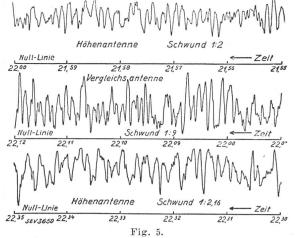
Schwundkurven der Höhen- und Vergleichsantenne bei 80 km.  $\lambda=192$  m.
