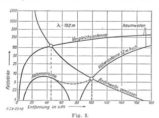
Feldstärkenkurven der Boden- und Raumwellen der Höhenantenne der Versuche in Eberswalde. Feldstärke in V/m.
