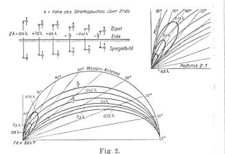
Einfluss der Höhe h des Strombauches des Dipols über der Erdoberfläche auf das Strahlungsdiagramm der Höhenantenne, die aus einem Dipol über der Erde besteht. Es ist hierbei
