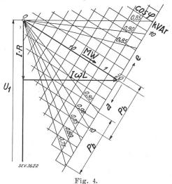
Spannungsdiagramm bei konstanter Belastung.
