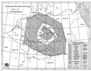
Fig. 4. Strahlungsfeld des Gross-Senders Leipzig.
