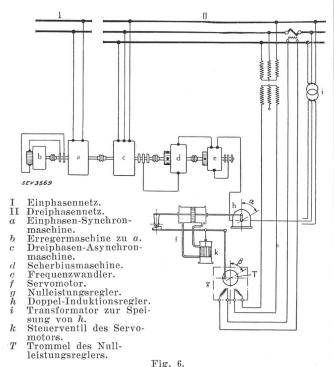
Vereinfachtes Schaltbild der Steuerung der Kollektorkaskade.
