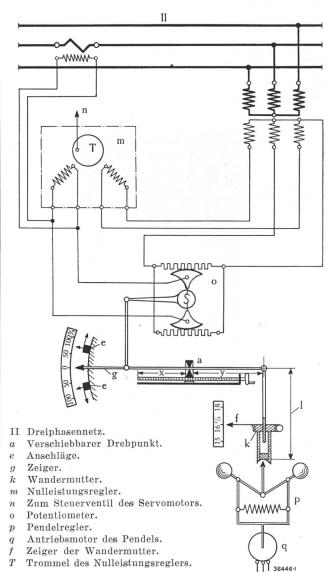
Fig. 10. Grundsätzliche Schaltung der automatischen Potentiometerregulierung
