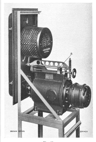
Ansicht des Potentiometers mit dem Pendelregler.
