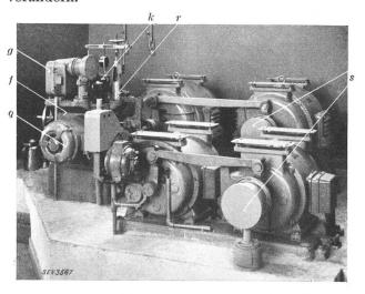
Fig. 4. Ansicht der Doppel-Induktionsregler.
