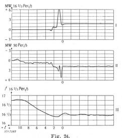
Registrierung eines Kurzschlussversuches, bei dem der Schalter der Einphasenmaschine zur Auslösung kam. Aufgenommen bei erhöhtem Papiervorschub von 5 mm/s.
