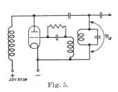
leitwiderstandes, da dadurch die Schwingungsamplituden begrenztwerden. Solche Gitterableitwiderstände werden auch bei den meisten folgenden Anordnungen mitverwendet.
