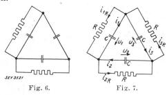
Sind die drei Teilkapazitäten und die drei Widerstände unter sich gleich gross, so lautet die Entladegleichung z. B. für den Teilkondensator 1
