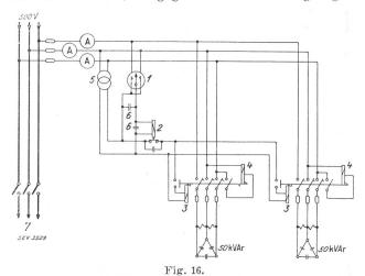
Schema eines Asynchronparallelbetriebes.
