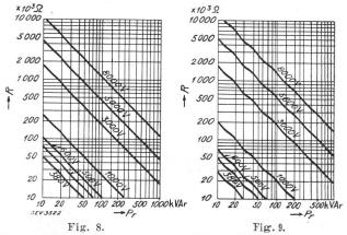
Maximal-Widerstand, wenn der Kondensator nach höchstens 10 s eine Spannung von 36 V erreicht haben soll. Minimal-Widerstand, wenn die dauernden Verluste im Entladewiderstand höchstens 0,15 % betragen sollen.
