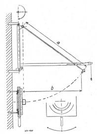
Fig. 2. Appareil pour l'essai de résistance mécanique. a = 100 cm; b = 71 cm.
