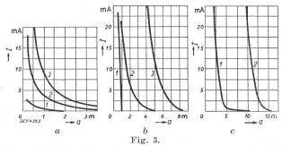
Strom I (50 Per./s.) in Funktion des Abstandes zwischen der Strahlrohrmündung und dem angespritzten Leiter  $\alpha$  (m).
