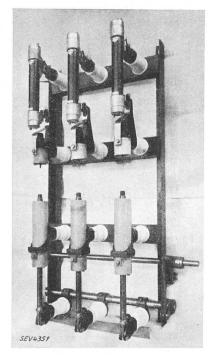
Fig. 9. Combinaison de l'interrupture autopneumatique avec un fusible à grande capacité de rupture.
