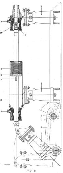
Interrupteur autopneumatique, type AS.
