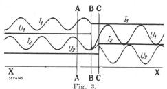
Oscillogramme d'un interrupteur autopneumatique 15 kV, 200 A.
