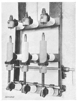
Fig. 1. Interrupteur autopneumatique 15 kV, 200 A.
