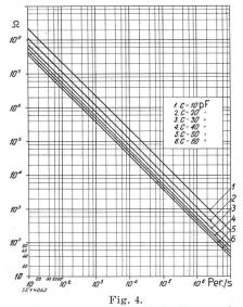
Ohmwerte der Schutzwiderstände, die im Frequenzbereiche von 10 bis 10<sup>7</sup> Per./s bei 10 bis 60 pF wirksamer Kapazität einen zusätzlichen Messfehler von —1 % bewirken.
