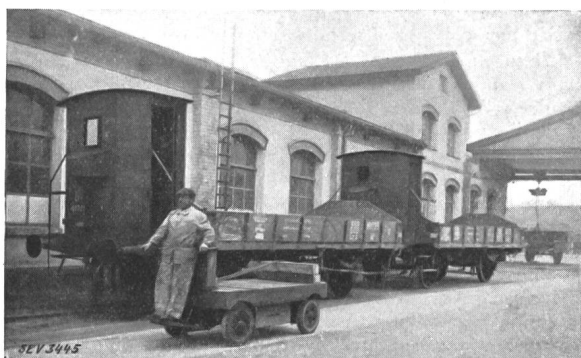
Fig. 6. Elektrokarren beim Ziehen von Eisenbahnwagen.
