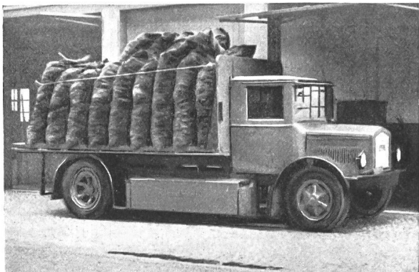
Fig. 11. Elektrolastwagen. Nutzlast 4000 kg. Aktionsradius 70 bis 80 km. Geschwindigkeit bis 30 km/h.
