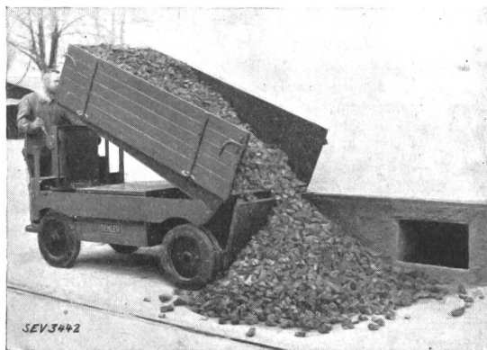
Fig. 8. Elektrokarren mit kippbarer Ladebrücke, 2 t.
