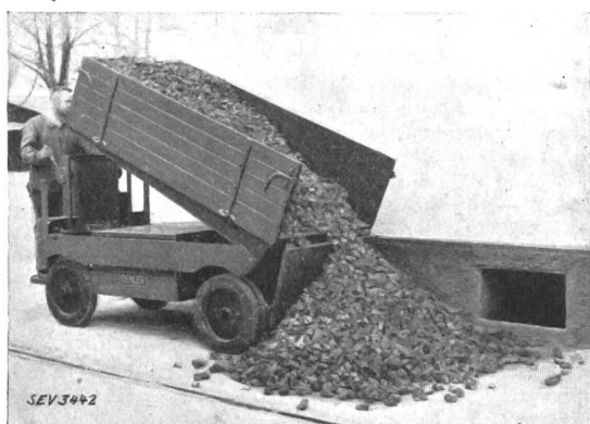
Fig. 8. Elektrokarren mit kippbarer Ladebrücke, 2 t.
