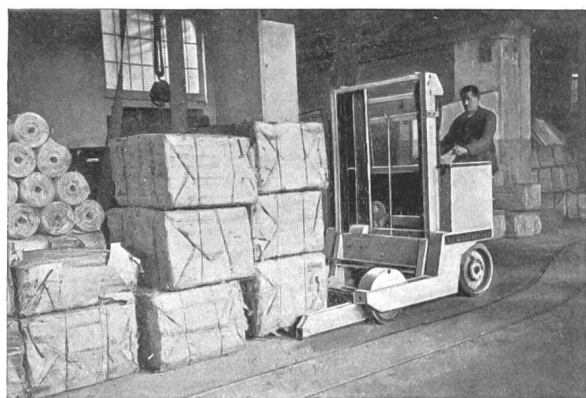
Fig. 15. Elektrostapler beim Abladen von Papierballen.
