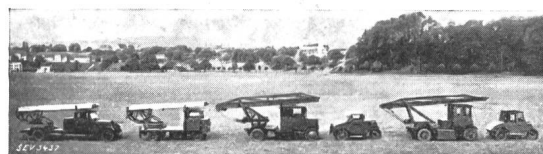
Fig. 21. Akkumulatorfahrzeuge im Dienste der elektrischen Strassenbeleuchtung der Stadt Zürich (EWZ).
