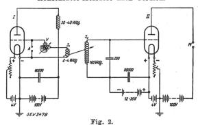
Schaltung der Kondensator-Messdose.
