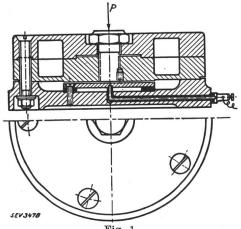
Fig. 1. Kondensator-Messdose nach Gerdien.
