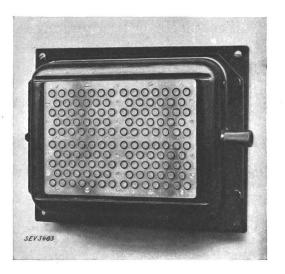
Fig. 6. Siccometerzelle.
