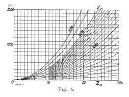
Dieses Verfahren kann durch Verwendung einer Kurvenschar nach Fig. 5 wesentlich vereinfacht werden, indem die theoretischen Eislastgewichte und die Beobachtungszeit im Maßstabe der Kurven auf ein Pauspapier aufgetragen werden und sodann durch blosses Auflegen die zugehörige Kurve ausgesucht wird.
