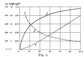
Essai d'accélération sur une minute (charge 10 600 kg).
