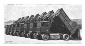
Fig. 11. Véhicules électriques employés à Lyon pour l'enlèvement des ordures ménagères.
