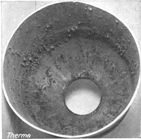
Fig. 32. Emaillierter Innenkessel mit Rostwarzen.
