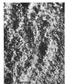
Fig. 26. Von Zitronensäure angegriffene Emaille. Vergrösserung ca. 40fach.
