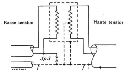
Isolation GS sous tube, au moins  $2,5 \text{ mm}^2$ , ou câble armé sous plomb non protégé, au moins  $2,5 \text{ mm}^2$ , ou fil nu d'au moins  $16 \text{ mm}^2$  sur poulies ou sous tube.
