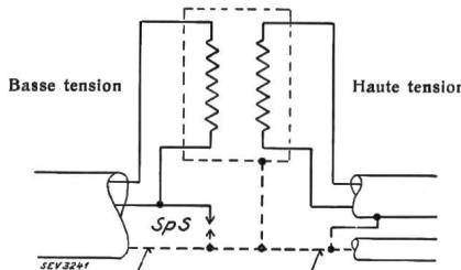
Isolation GS sous tube, au moins  $2,5 \text{ mm}^2$ , ou en montage apparent sur poulies ou sous tube, au moins  $6 \text{ mm}^2$ .
