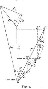
erkennt man die Phasenverschiebungen der einzelnen Ströme  $\psi$  gegenüber dem Gesamtstrom bei drei parallel arbeitenden Transformatoren. Die Phasenverschiebungen rühren von den ungleichen Kurzschlussimpedanzen her, d. h. von den ungleichen charakteri-Dreiecken stischen AA'B' OAB. und A'A"B". Sie haben zur Folge, dass die Phasenverschiebungen  $\varphi$  der einzelnen Ströme gegenüber der
