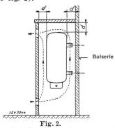
$d=\min$ . 8 cm pour les chauffe-eau à accumulation au-dessus de 100 litres.  $d=\min$ . 4 cm pour les chauffe-eau à accumulation jusqu'à 100 l.
