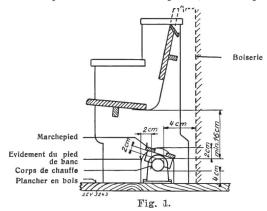
Dans les installations de chauffage d'une puissance nominale supérieure à 500 watts par mètre courant, ces écartements minima seront accrus selon la charge. Au poste de commande principal de ces installations, un écriteau doit être apposé, attirant l'attention sur le danger d'incendie si l'on recouvre des corps de chauffe par des objets gênant la circulation de l'air (tapis et autres).
