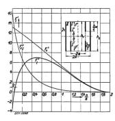
Axialkräfte zwischen Röhrenspulen bei symmetrischem Abschalten
